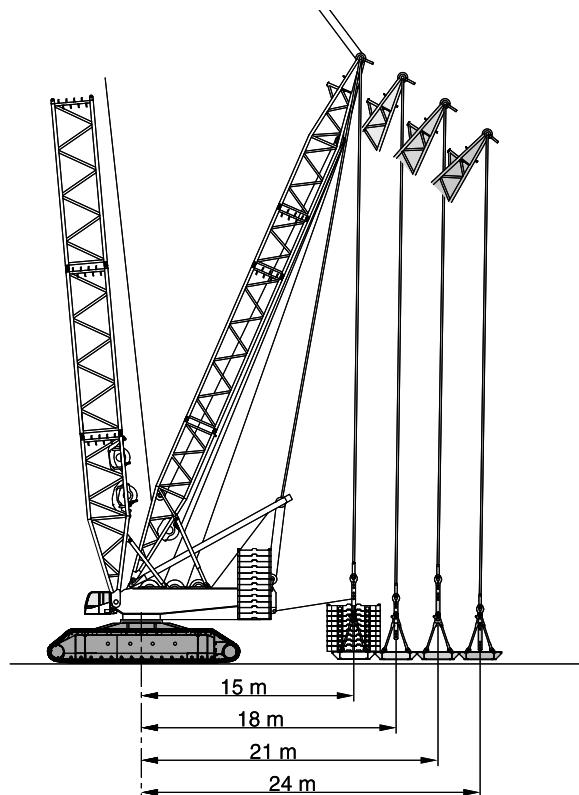
Variable Superlift attachment · Variable Superlifteinrichtung · Superlift variable · Configurazione Superlift variabile · Accesorio Superlift variable · Acessório Superlift variável · Оборудование суперлифт с регулировкой по весу подъема
